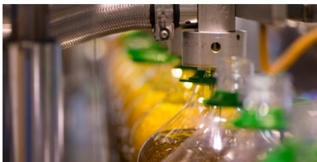
El **embotellado en atmósferas inertes** ayuda a evitar estos efectos negativos. Consiste en eliminar el aire de envasado en el cuello de la botella, mediante barrido de  $N_2$  o con vacío compensado.
